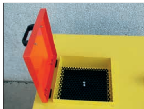
Vano scola filtri
